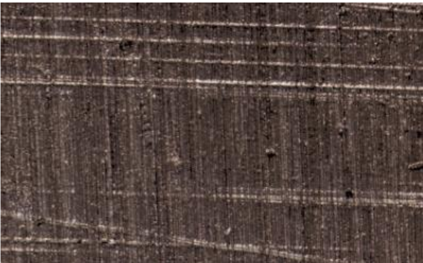
Depois o tratamento, 21.11.2015 - Ra = 0,743 \mu m
