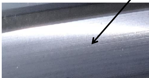
Imagens 5 e 6: Molde retirado do aerogerador n° 9 depois do tratamento. Os danos causados por atrito desapareceram por completo.
